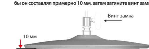
\* Если сделать зазор меньше, извлекать звуки хай-хэта будет проще. Однако при слишком узком или широком зазоре устройство может работать некорректно или вовсе звука не воспроизводить. Зазор шириной 10 мм обеспечивает наибольшее естественные ощущения при игре на VH-10D.
