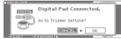
\* Если выбрать тот же триггерный вход, что и для пэда, подключенного к разъему TRIGGER IN, пэд, который подключен к этому разъему TRIGGER IN, звука производить не будет.
