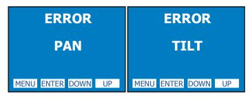
PAN REPOSITIONING **ENCODER ERROR**
