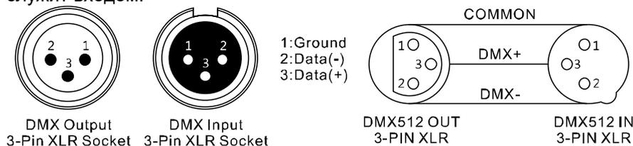
Для установок с очень длинным DMX-кабелем или из-за высоких электрических помех, например, на дискотеке, рекомендуется использовать «DMX-терминатор». «DMX терминатор» будет служить XLR-разъему как сопротивление 120 Ом. между контактами 2 и 3, и вставляется в последний выходной разъем DMX-линии.
