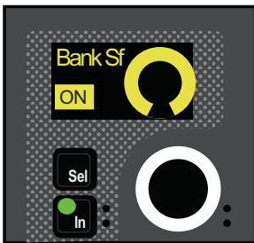
Bank Safe parameter on a CKM encoder
